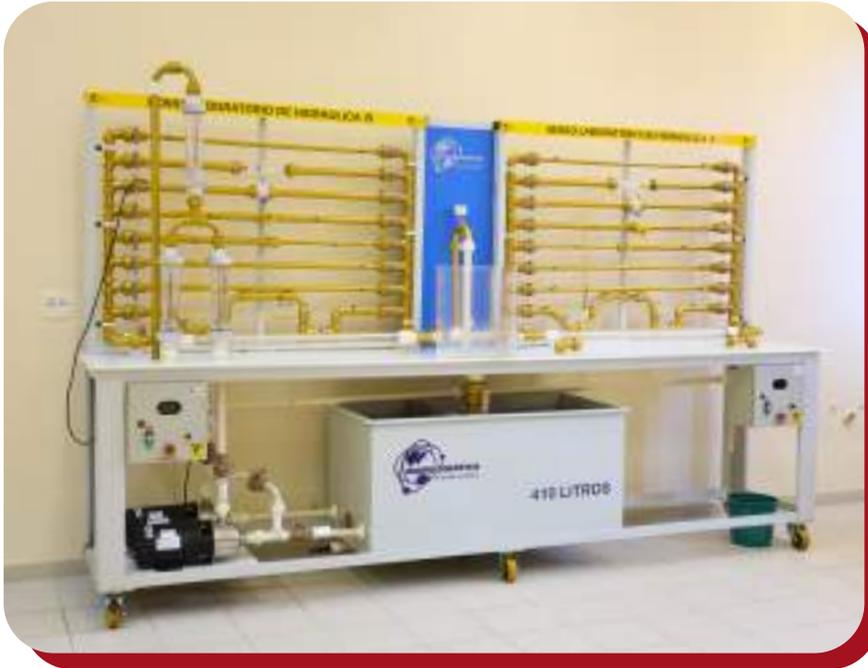
Utilizado para o desenvolvimento de estudos práticos e pesquisa de hidrostática e hidrodinâmica com enfoque em manometria e hidrometria.
